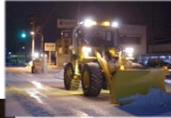
↑道路の機械除雪状況
