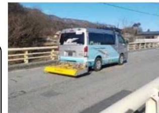
電磁波技術を利用した床版上面の損傷把握
