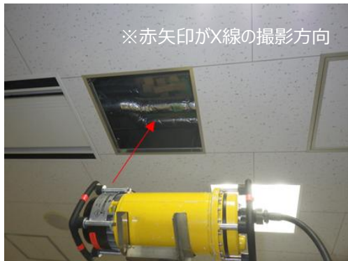
X線透過検査の様子と取得画像
