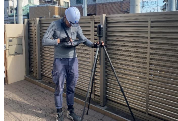
<レーザースキャナによる建物外部の点群測定>
