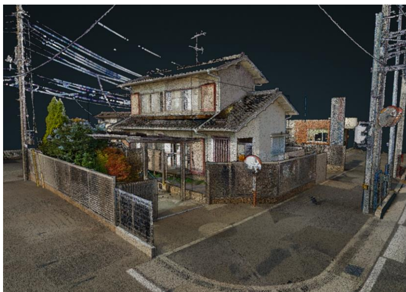
図 18 合成処理後の点群データ
