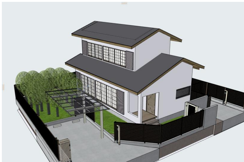
図 21 点群データを参照し Archicad・BI for ac で作成した BIM モデル
