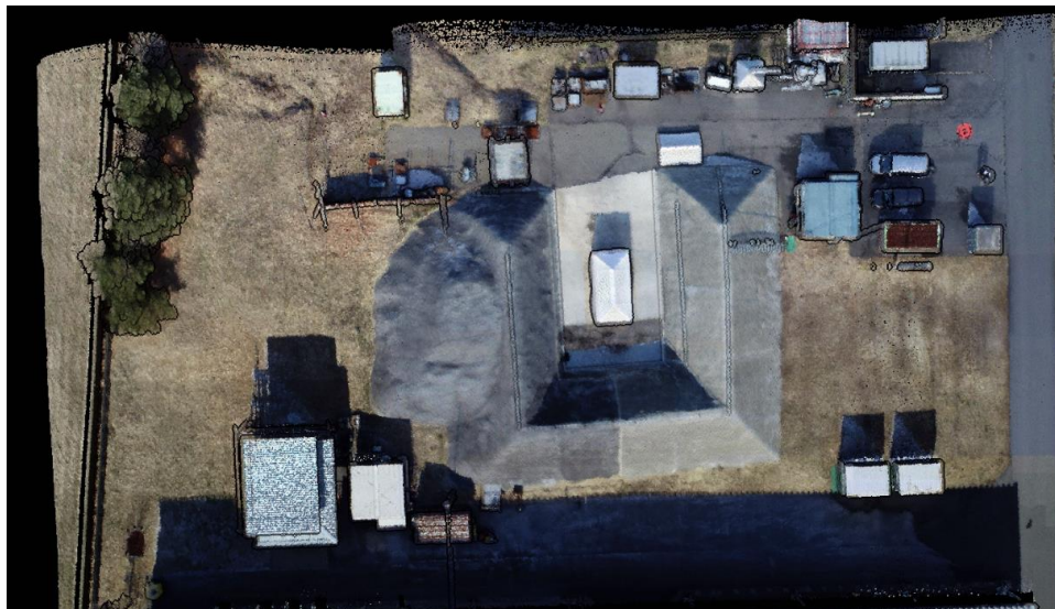
図 3.2-36 ドローンによる点群取得結果
