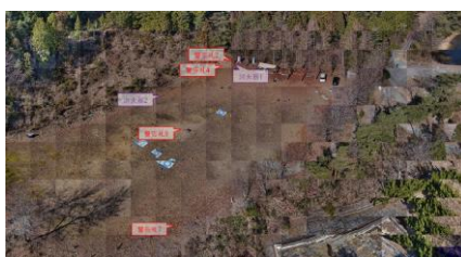
図 3.2-78 AI 検出結果の俯瞰図（離隔距離 100m、高度 60m）
