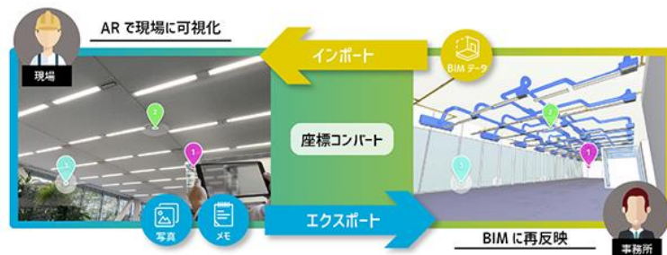
図 3.2-106 Pinspect の BIM 連携イメージ
