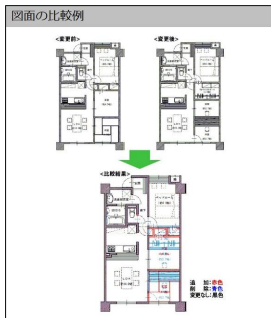
図 2.1-13 変更点の差分解析イメージ
