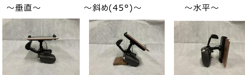
図 3.2-21 Skydio2+の操縦装置の角度
