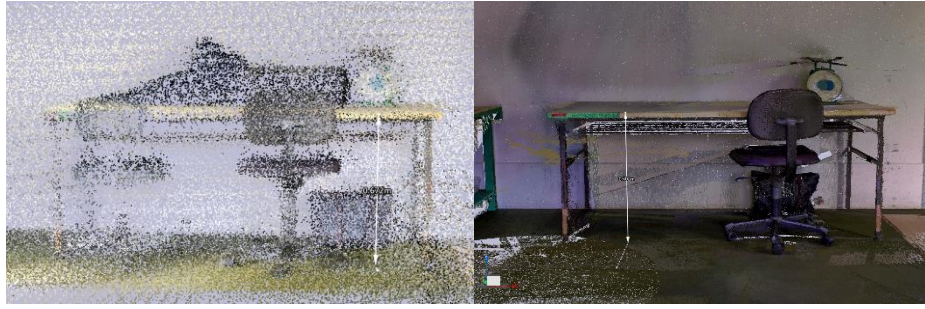
図 3.2-38 危険工室（左：携帯型レーザスキャナ、右：地上型レーザスキャナ）
