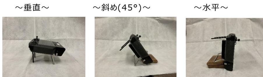
図 3.2-20 Matrice300RTK の操縦装置の角度
