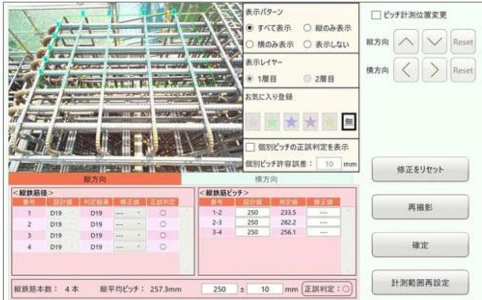
図 4 配筋検査システムの表示画面
