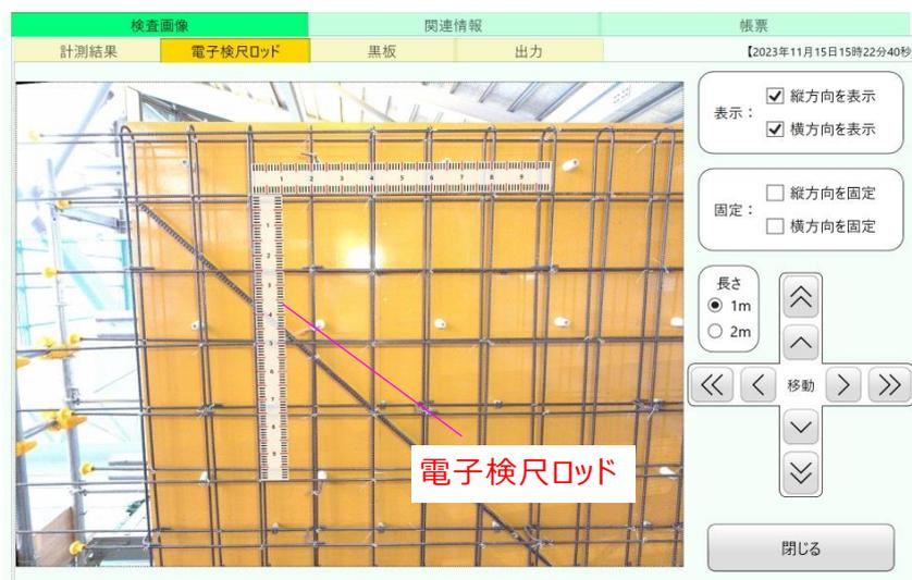
図 26 配筋検査システムの電子検尺ロッド表示画面
