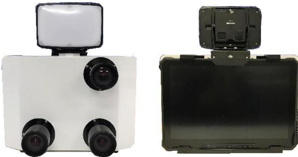
図 3 配筋検査システム
