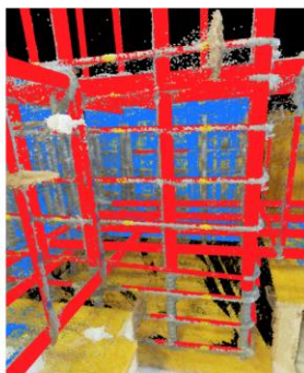
図 30 BLK360 G2 で取得した点群から生成した 3D モデル（詳細な部位）
