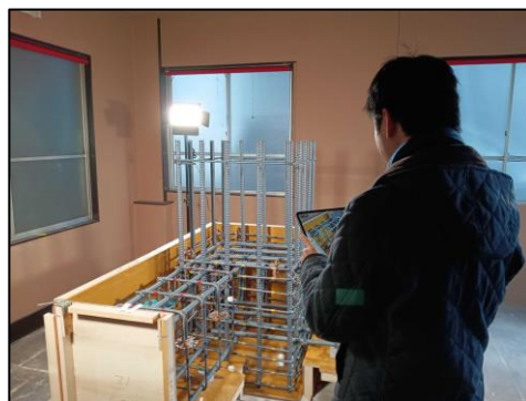
図4 点群の撮影の様子
