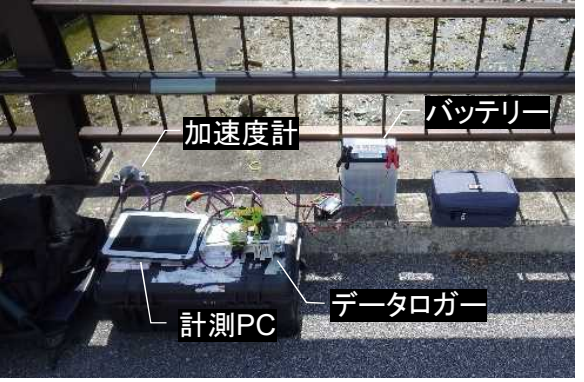
センサーを活用したたわみ計測
