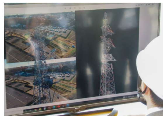
AI技術による診断 (鉄塔の状態、障害箇所等)
