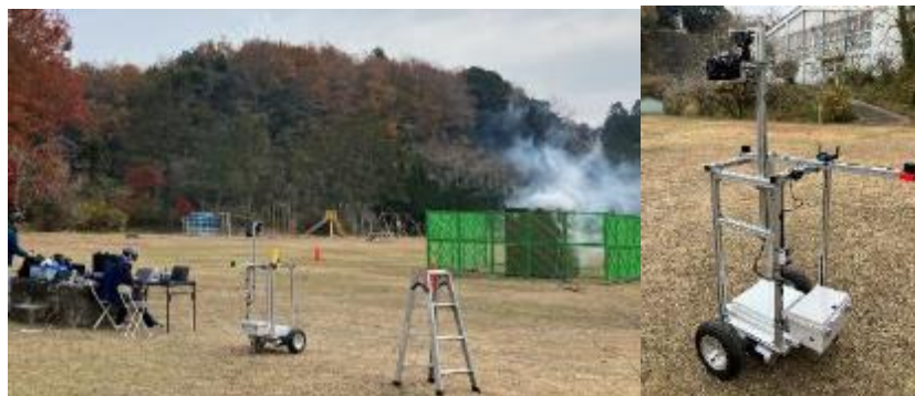
図 56 模擬火薬類取扱所近くで待機する UGV の様子（左）と UGV 本体（右）
