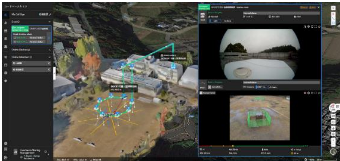
図 30 DJI FlightHub2(運航管理システム)のモニタリング画面
