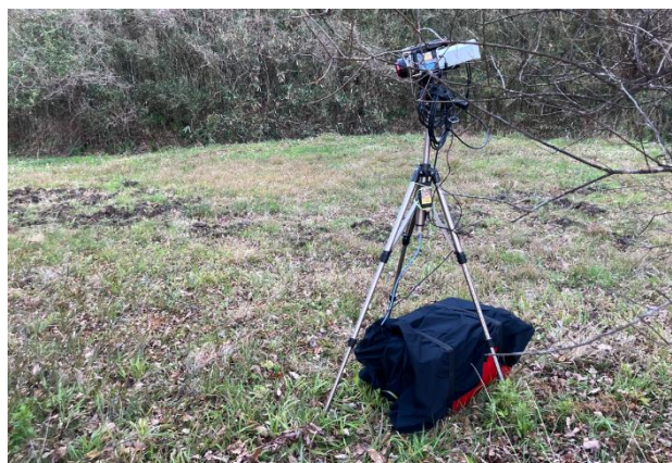
(5)残存熱を撮影する際の野外サーモカメラの設置
