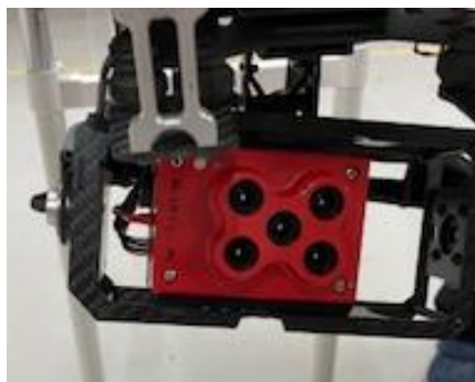
図 11 ドローンに搭載するマルチスペクトルカメラ(MicaSenseRedEdge)
