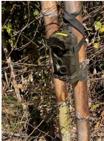
図 7 固定赤外線カメラの設置（トロフィーカム）
