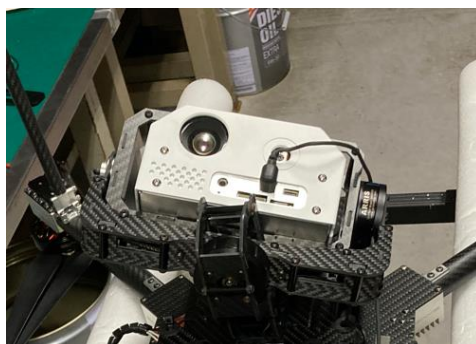
図 9 ドローン用熱赤外線カメラ (日本アビオニクス製開発機)
