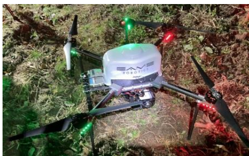
図 8 熱赤外線カメラを搭載するドローン (E470)
