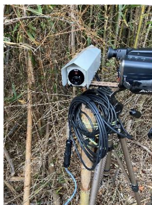
図 10 野外サーモカメラ (N50 シリーズネットワークサーモカメラ)
