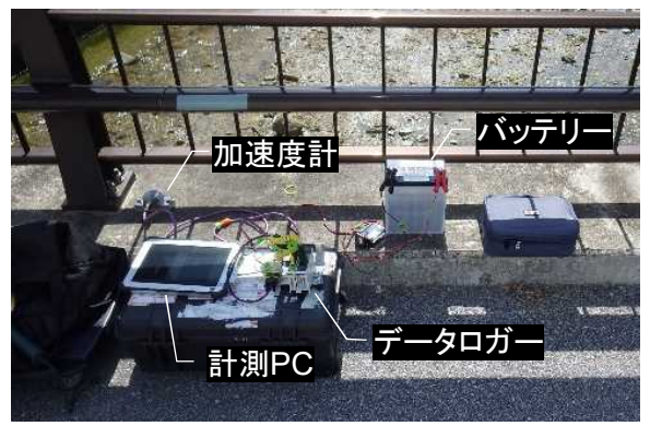
センサーを活用したたわみ計測
