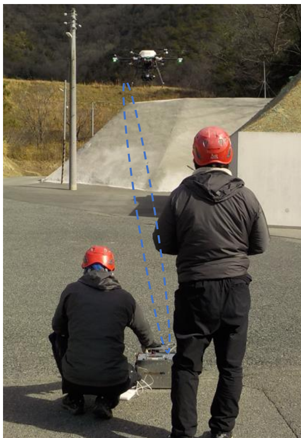
図 15 ドロンスパイダーによる係留 (点線囲み部分にワイヤーがあり、ドローンの足と繋がっている)
