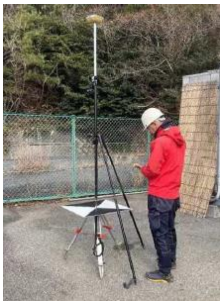
図 4 滞空標識の設置と測量状況
