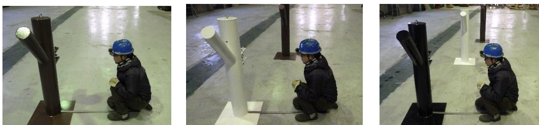
図 16 検査員による模擬劣化サンプル品の目視確認の様子
