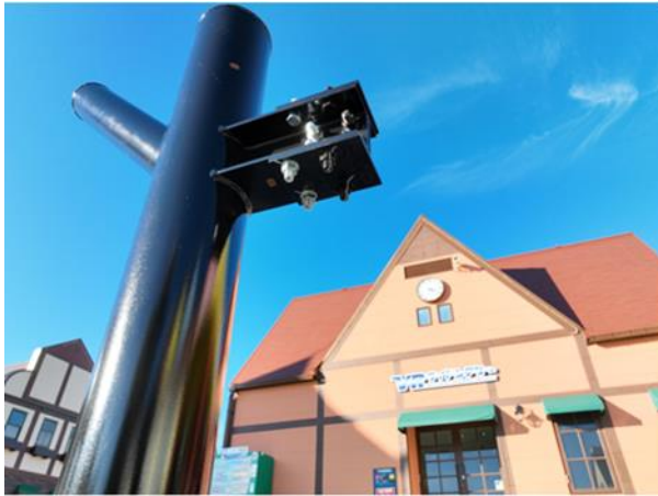
模擬劣化サンプル品 構造部材下面 (Mavic3) 望遠カメラでは構造部材下面は撮像できなかったため、 広角カメラに切り替えた。
