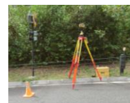
測量機器:GNSS HiperV
