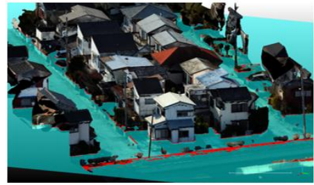
②代表点座標CのZ座標と同値の浸水面を再現し、各家屋と浸水面の交点として浸水線(赤線)を投影
