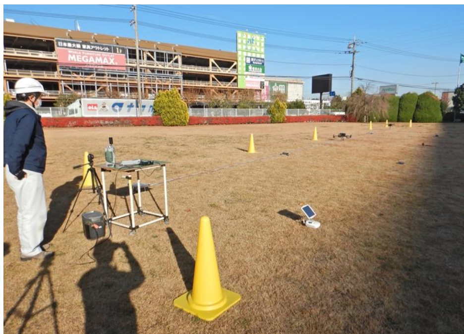
図 94 ドローン直線配置 相互離隔 6m
