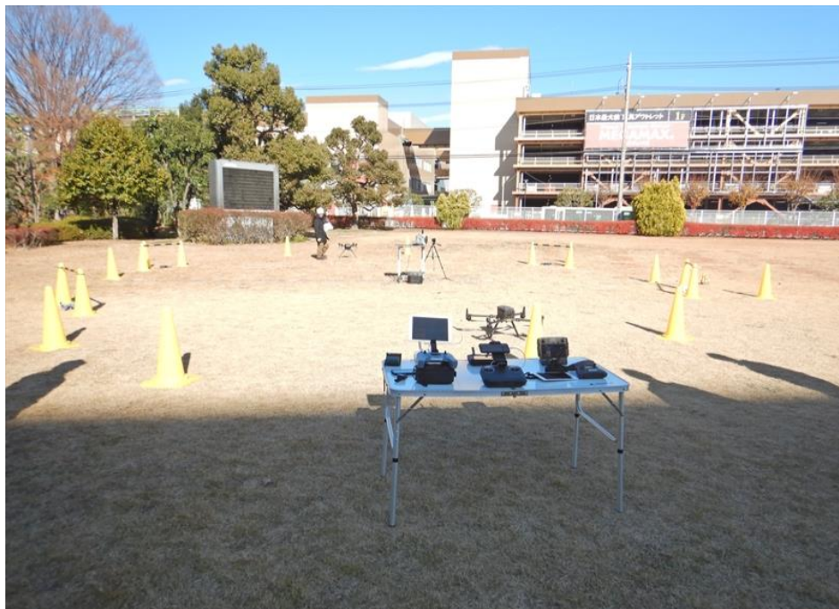
図 86 ドローン円周配置 相互離隔 6m 実施状況
