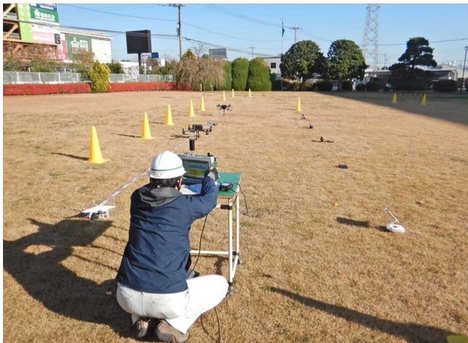
図 90 ドローン直線配置 相互離隔 3m
