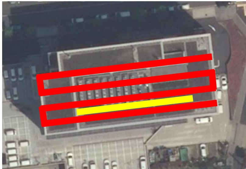
図 108 飛行ルート図(赤：カメラ角度-90 度、黄：カメラ角度-45 度)
