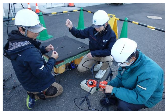
図 63 係留装置設置作業状況(左)1 点係留、(右)2 点係留
