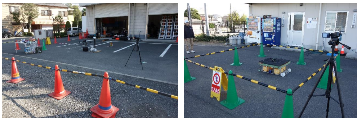
図 31 第 3 者立ち入り禁止措置状況(左)1 点係留、(右)2 点係留
