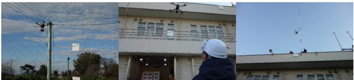
図 58 係留装置なし、1 点係留、2 点係留の撮影画像 (左) 係留なし、(中央) 1 点係留、(右) 2 点係留
