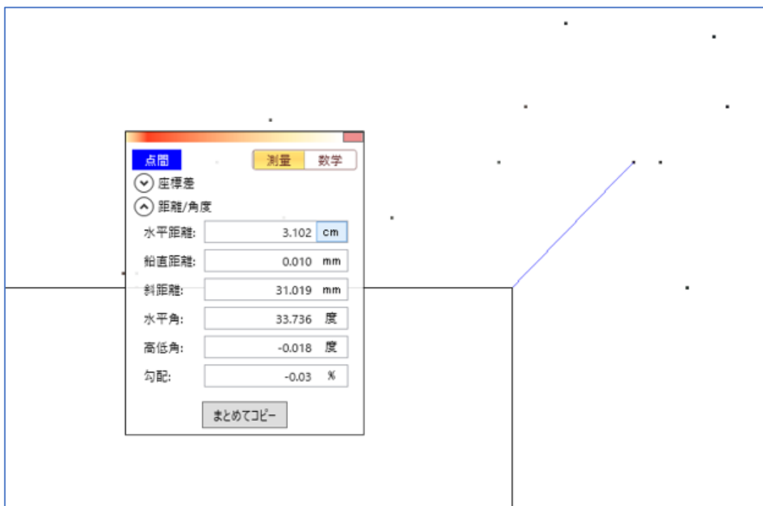
図 116 ①の 3D データの角と最も近い点との距離を計測した図
