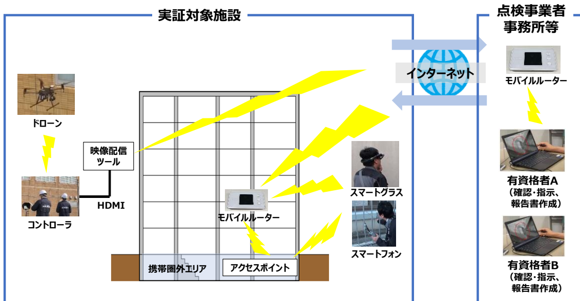
図 2 本技術実証の使用機器やシステム構成のイメージ
