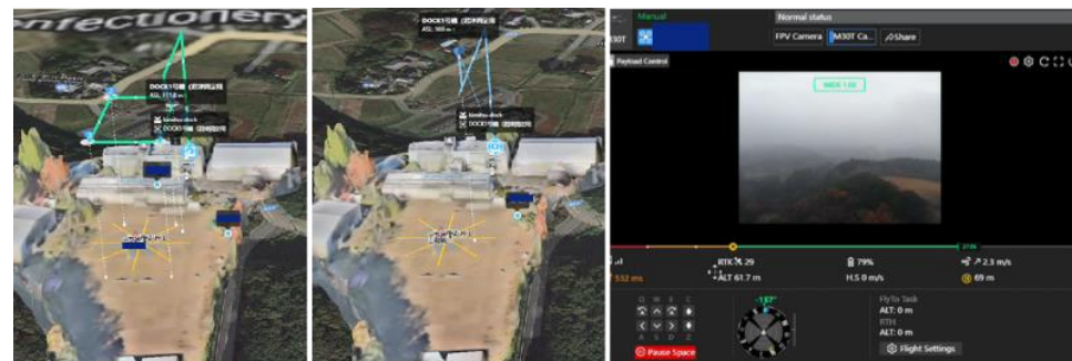
自律飛行停止・介入操作の実証の様子（左：自律飛行中の飛行ルート、中：介入操作に切替後の飛行ルート、右：介入操作を行った際の操作画面）
