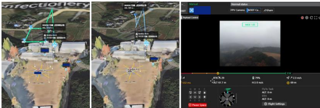
b.自律飛行停止・介入操作の実証の様子（左：自律飛行中の飛行ルート、中：介入操作に切替後の飛行ルート、右：介入操作を行った際の操作画面）
