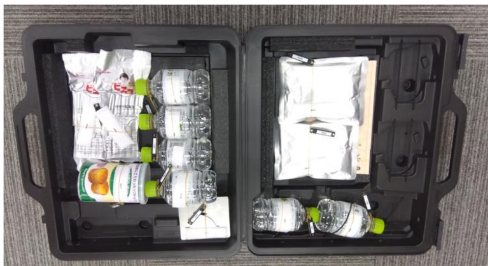
図 34 RF タグを貼り付けた救命艇艀装品を模したケース
