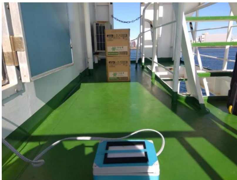
図 68 光学センサー (LiDAR) 実証実験 1 の通路と障害物
