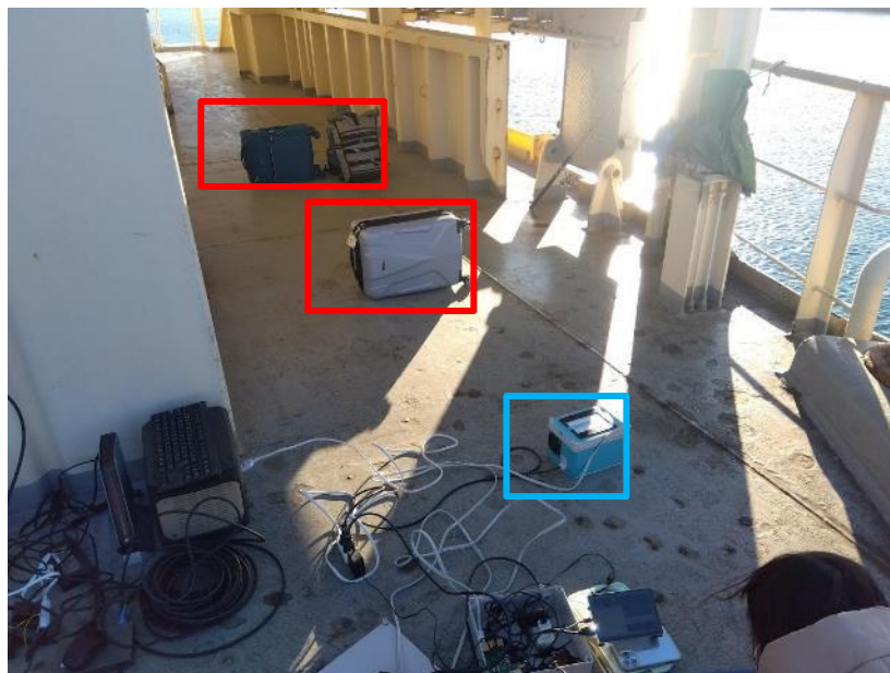
図 19 船舶での光学センサー（青枠）による障害物検知実証実験の様子
