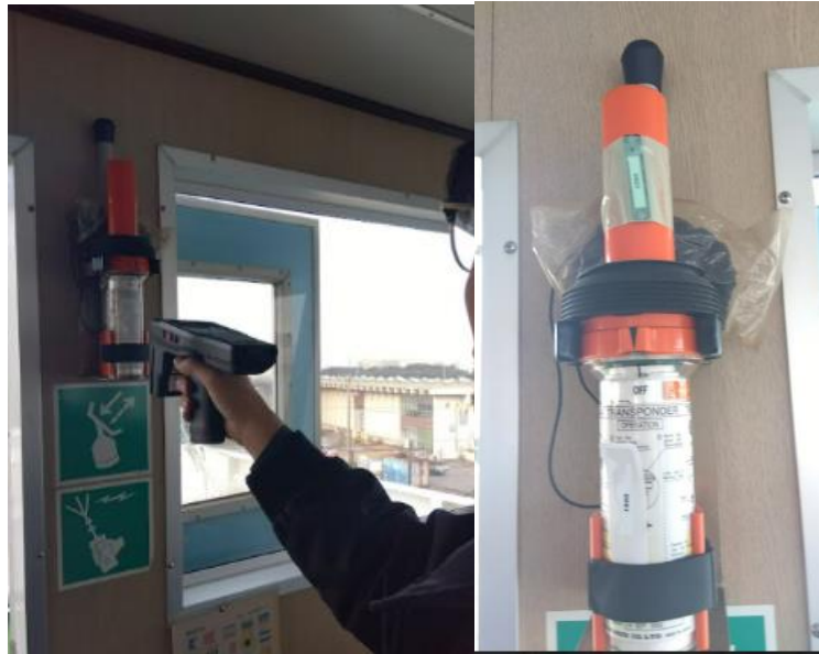
図 29 RF リーダにて点検を行う様子
