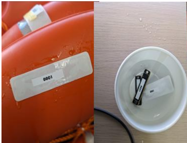
図 30 耐水性試験 タグ濡れ、水中試験の様子
