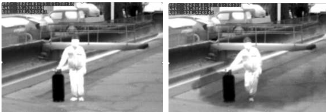
図 101 LP ガスボンベから（左）ガスを漏えいさせる前（右）ガスを漏えいさせた後
