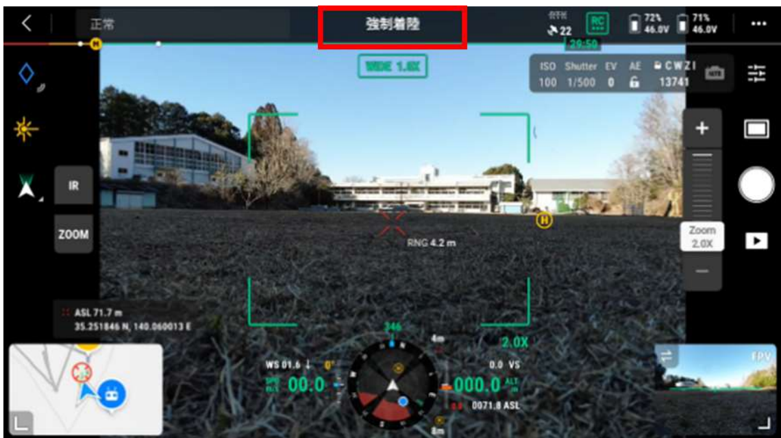
図 162 衝突機能が作動し、強制着陸した様子
