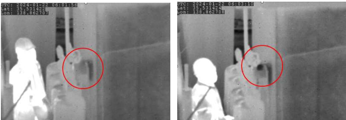
図 167 ガスメーターから(左) ガスを漏えいさせる前(右) ガスを漏えいさせた後
