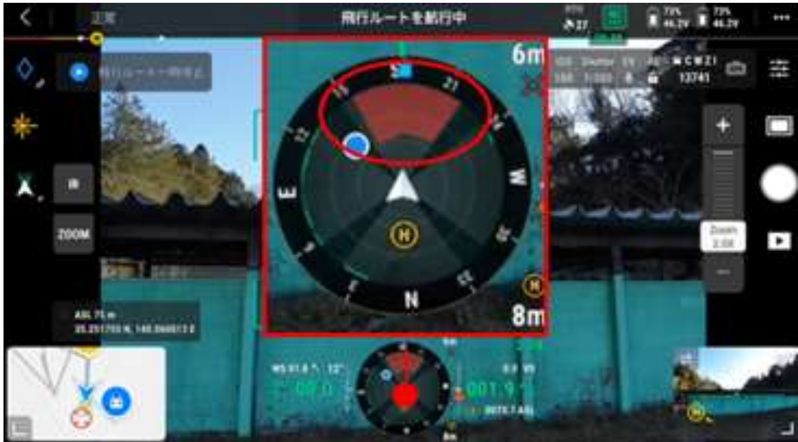
図 161 衝突防止機能が働いている様子
