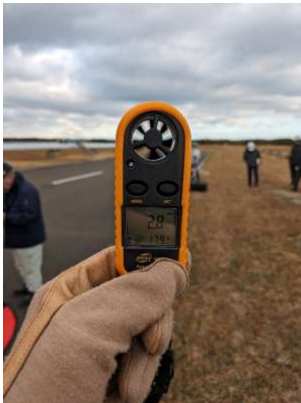
図 47 安全管理 風速の確認（ひびき LNG 基地）
