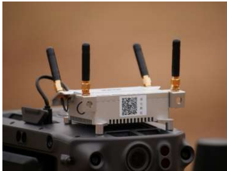
図 12 通信モジュール 搭載状態
