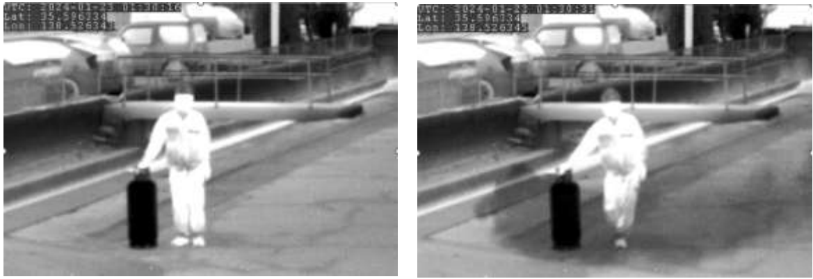
図 168 LP ガスボンベから（左）ガスを漏えいさせる前（右）ガスを漏えいさせた後
