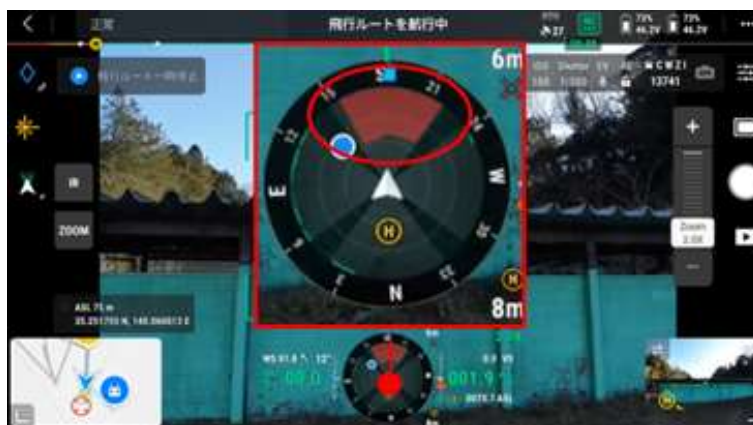
図 183 衝突防止機能が働いている様子
