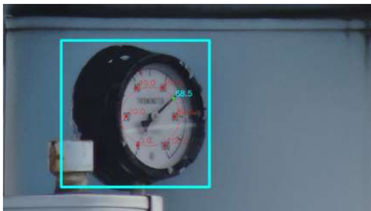
図 143 LPG 増熱器に設置されているメーターの AI 解析結果
