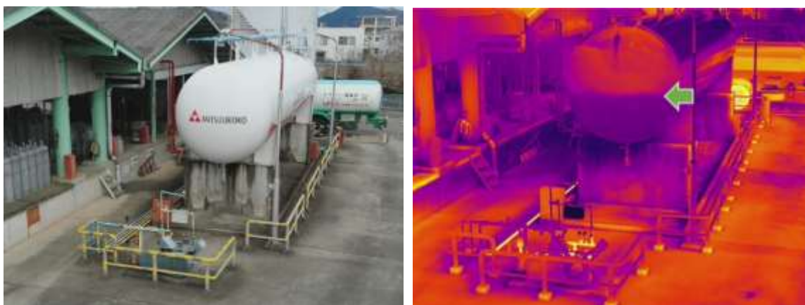
図 53 LPG 貯槽のサーマルカメラでの撮影結果(矢印までがタンク内の液量)
