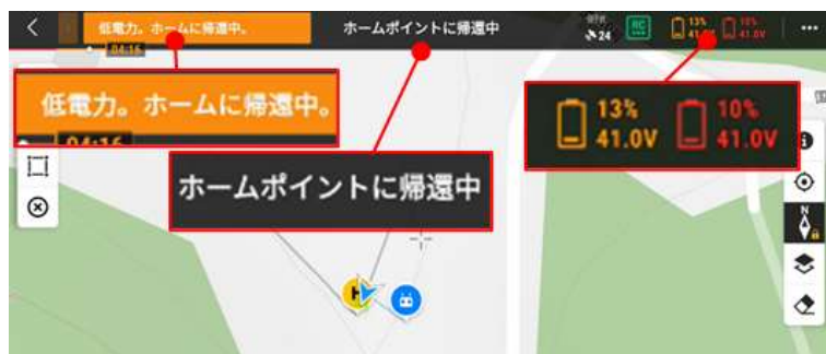
図 157 バッテリー残量低により強制的に RTH する画面
