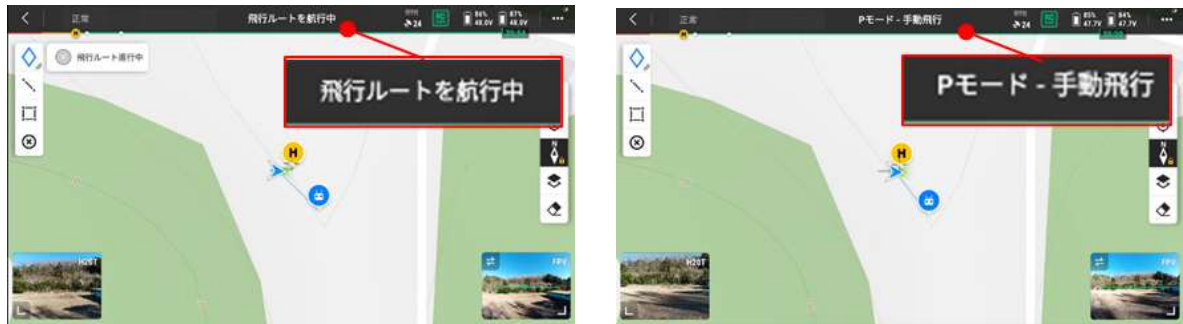
図 181 ドローンのコントローラー上での(左)自律飛行中と(右)自律飛行機能喪失後のマニュアル飛行中の飛行の様子
