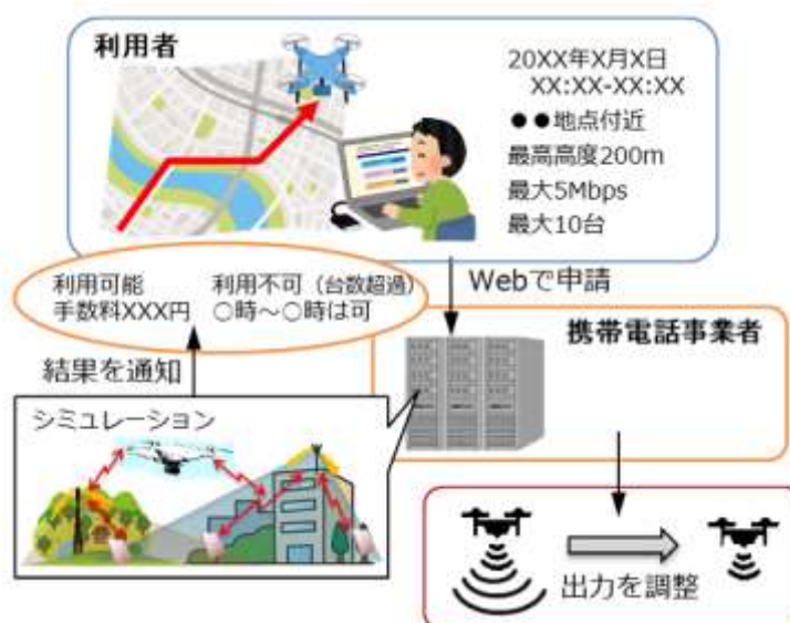
図 45 携帯電話の上空利用のサービス利用イメージ (総務省 無人航空機等における携帯電話等の端末の利用・総務省・閲覧日 2024/01/30・
