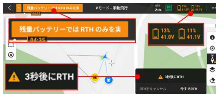
図 156 バッテリー残量低による RTH の警告画面
