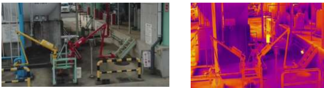
図 63 ローディングアームのサーマルカメラでの撮影結果
