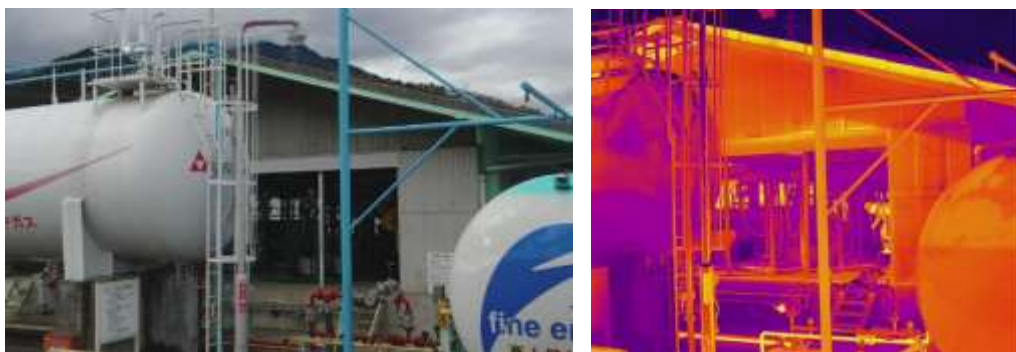
図 60 充てん機付近をサーマルカメラで撮影した結果
