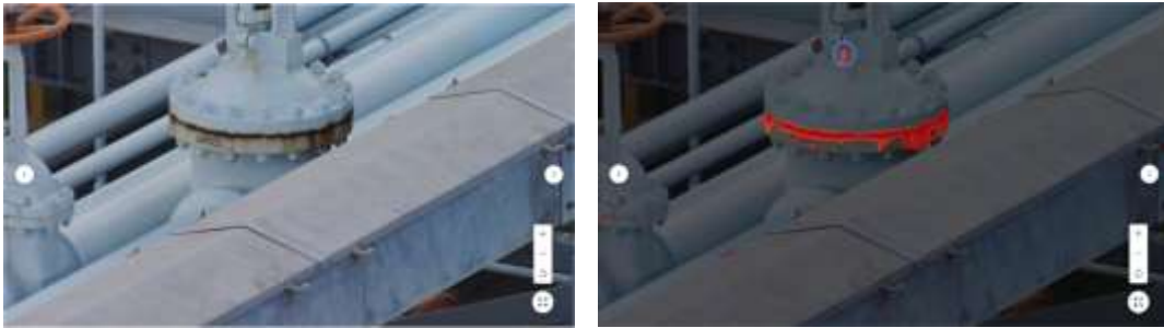
図 137 LPG 貯槽の錆の AI 解析結果 1
