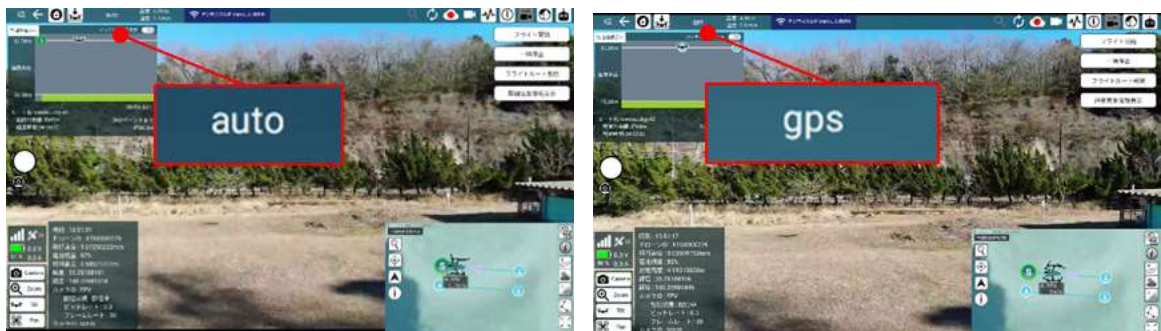
図 154 運航管理システム上での(左)自律飛行中と(右)自律飛行機能喪失後のマニュアル飛行中の飛行の様子
