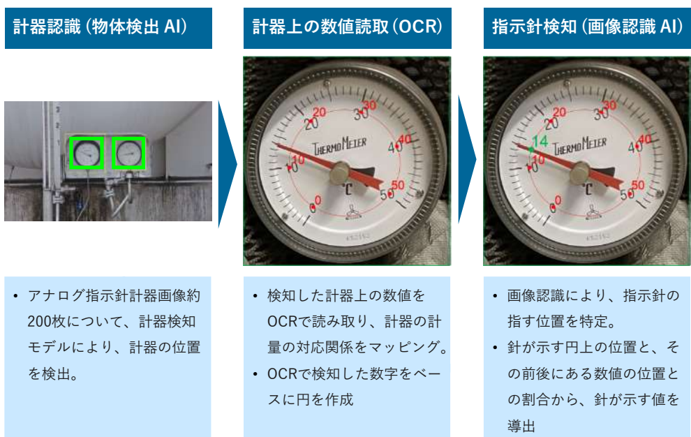
図 17 メーターモデルの処理ワークフロー
