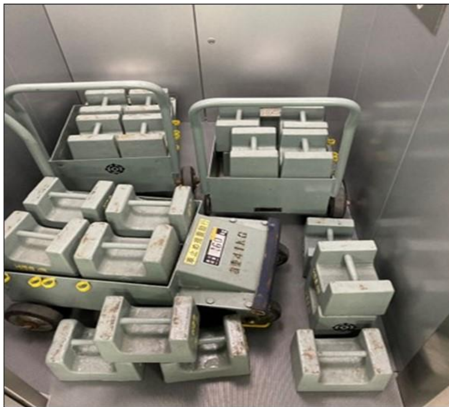
図 18 実証の様子：[従来手法]かご内へ錘を載せた状態
