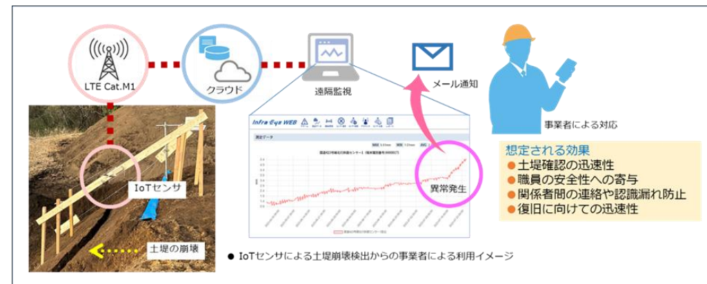
図2 IoTインフラ遠隔監視システムによる実証の全体像
