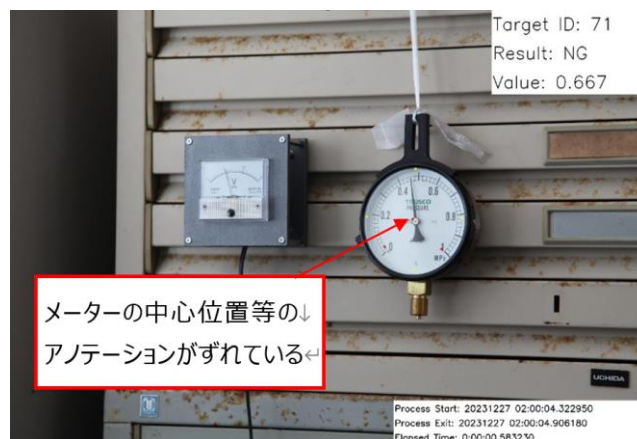
図 87 カメラ位置がずれ、読み取りに失敗した画像※
