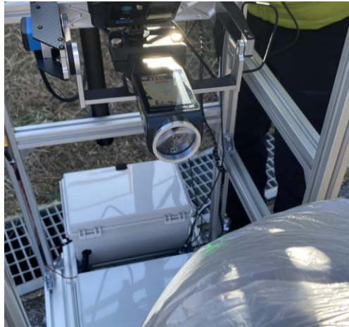
図 44 ガスが入った袋にガス検知器のレーザーを照射している様子
