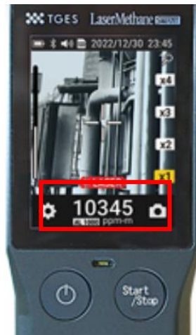
図 46 ガスを検知した際には濃度が表示される※
