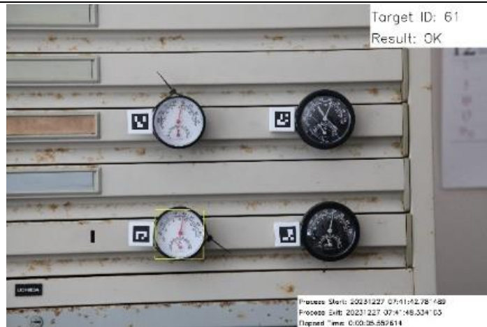
図 82 温度計の外観の劣化なし※
