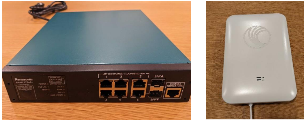
図 17 使用機材（左：PoE ハブ、右：無線中継機）
