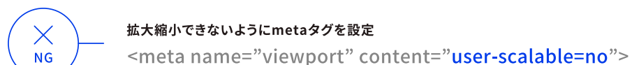
図3.14 スマートフォンでの拡大縮小を無効にする「user-scalable=no」は使用しない
