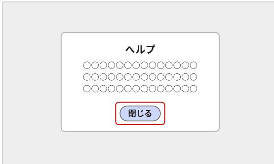
図3.2 ダイアログ内にフォーカス可能な閉じるボタンを置くことで、キーボードで閉じられるようにする
